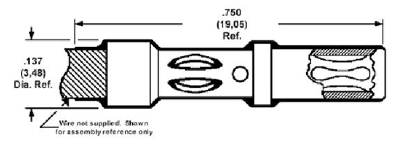
Min hole depth (socket) .185 (4,70)
